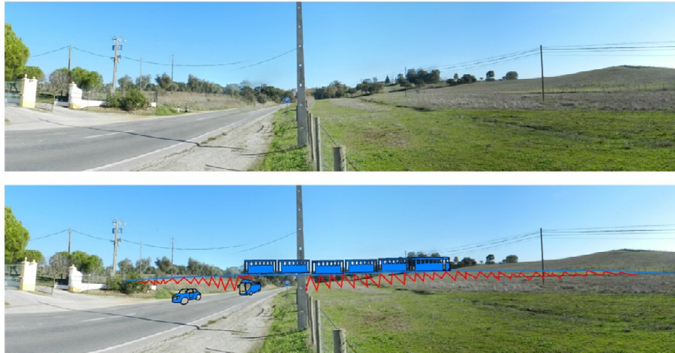
Fig. 8 Passagem inferior da EN254 sob a ferrovia / ANTES e DEPOIS
