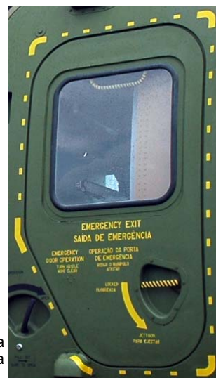
Área de corte de emergência e pega exterior de uma porta
